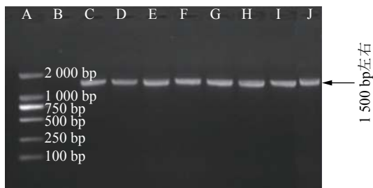
注：各条带从左到右 A、B、C、D、E、F、G、H、I 和 J 分别为 2 000 bp Marker、阴性对照、Q1、Q2、Q3、Q4、A1、A2、D1 和 D2，各细菌条带大小均为 1 500 bp 左右。
