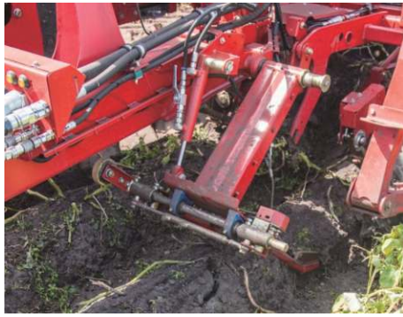
a) 自动对垄技术 automatic ridge alignment technology
